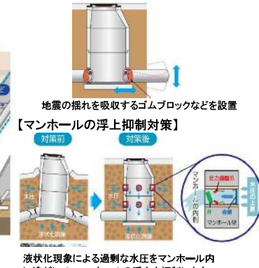
【下水道管とマンホールの接続部の耐震化】
